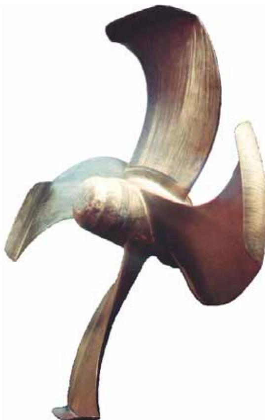
La Nuova Teoria del Momento permette, oltre alla progettazione di eliche convenzionali, anche la progettazione di eliche CLT SISTEMAR, eliche ad apice caricato e contratto (CLT è l'acronimo di Contracted and Loaded Tip).
